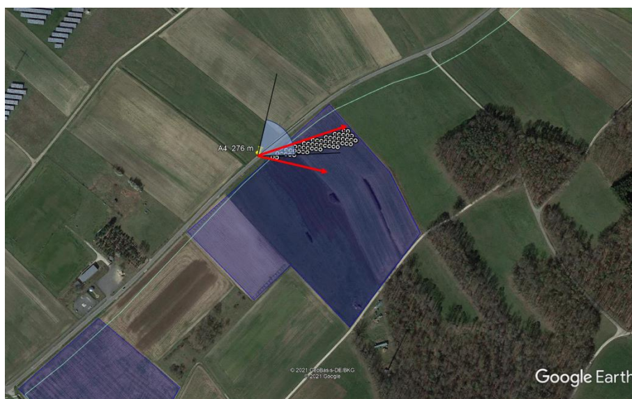
Abbildung 29: Vergleich Sichtfeld Zugführer für Punkt A4 mit Grenzvektoren in Richtung Module (Azimut = 180°)
