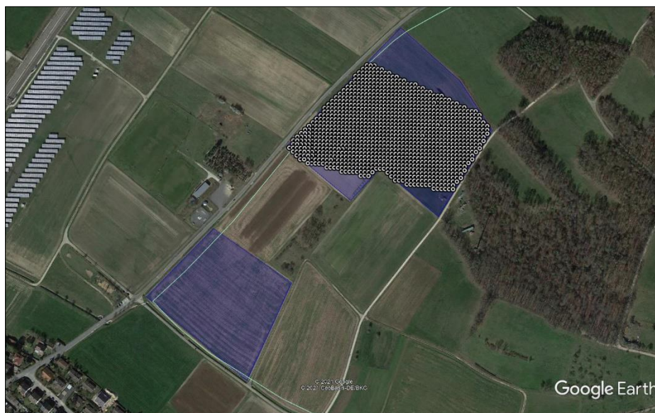
Abbildung 27: Spezifischer Emissionsbereich für Punkt O3 am Ortsrand Bräuningshof (Azimut = 180°)
