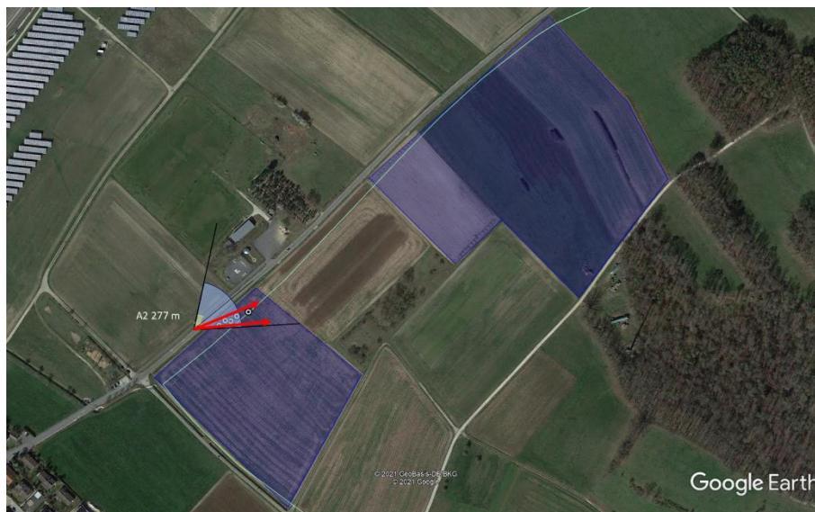
Abbildung 28: Vergleich Sichtfeld Fahrzeugführer für Punkt A2 mit Grenzvektoren in Richtung Module (Azimut = 180°)
